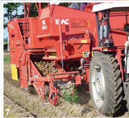
1 - Barra di traino per aggancio inferiore, piede d'appoggio idraulico 2/3 - Pick-up costituito da vomere a 2 vanghe ad inclinazione regolabile, rullo tastatore pendolare, 2 dischi tagliaerba montati su molle che possono essere azionati idraulicamente (opt.) 4 - Nastro defogliatore a maglie larghe che avvolge il nastro elevatore con falcini di gomma 5 - Separazione del prodotto, sistema P.D.R. pettine a dita rotanti regolabile idraulicamente 6 - Sensore per il caricamento automatico della tramoggia (opt.) 7 - Raccolgitrice ad una fila laterale al lavoro 8 - Scatola ingranaggi a due velocità (opt.) 9 - Controllo automatico della profondità di scavo (opt.)
