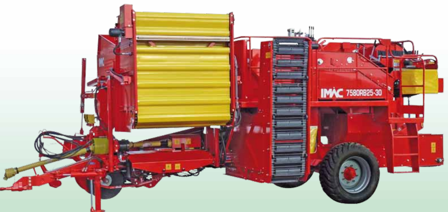
1 - Barra di traino per aggancio inferiore, piede d'appoggio idraulico 2/3 - Pick-up costituito da vomere a 2 vanghe ad inclinazione regolabile, rullo tastatore pendolare, 2 dischi tagliaerba montati su molle che possono essere azionati idraulicamente (opt.) 4 - Nastro defogliatore a maglie larghe che avvolge il nastro elevatore con falcini di gomma 5 - Separazione del prodotto, sistema P.D.R. pettine a dita rotanti regolabile idraulicamente 6 - Sensore per il caricamento automatico della tramoggia (opt.) 7 - Raccolgitrice ad una fila laterale al lavoro 8 - Scatola ingranaggi a due velocità (opt.) 9 - Controllo automatico della profondità di scavo (opt.)
